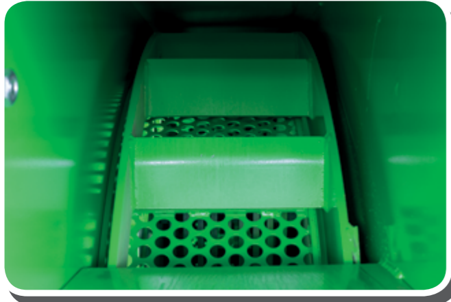
Detalle de rejilla Ø2,5-3 cm. y martillos de corte (vista interior)
